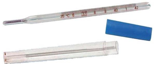
Altro liquido comunemente usato è l'*Alcool* entrambi si dilatano all'aumentare della *Temperatura* molto più del vetro che li contiene. Il *Bulbo* è collegato con un *Tubo Capillare* che viene chiuso all'altro estremo dopo aver estratto l'*Aria*. Poiché il *Volume del Liquido* varia al variare della *Temperatura T* a cui si trova lo strumento, anche l'*Altezza h della Colonnina di Liquido nel Capillare* è una *Funzione della Temperatura*.
